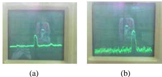
Gambar 7. Sinyal Keluaran Pemancar ASK Pada Frekuensi Span : (a). 10 MHz/div dan (b) 500 KHz/div
