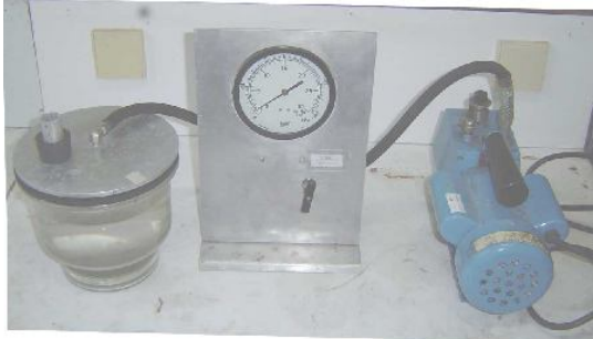
Gambar 7. Alat uji kebocoran dengan metode bubble test
